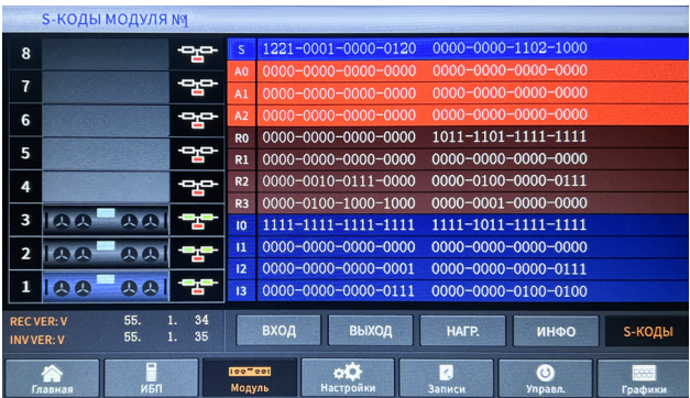
4. S-коды силового модуля
