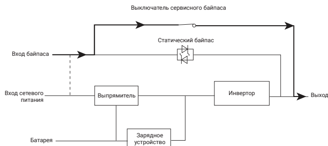
Структурная схема работы ИБП в режиме сервисного байпаса
